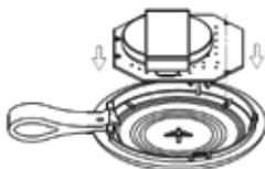
3. Установите нижнюю крышку корпуса, в соответствии с вырезом ремешка, со смещением на 1,5 мм. Прижмите крышку у ремешка и сдвиньте ее вниз. Далее, осторожно нажимая на крышку, закройте корпус брелка.
