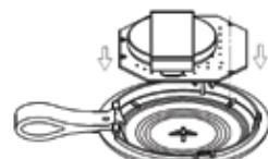
3. Установите нижнюю крышку корпуса, в соответствии с вырезом ремешка, со смещением на 1,5 мм. Прижмите крышку у ремешка и сдвиньте ее вниз. Далее, осторожно нажимая на крышку, закройте корпус брелка.
